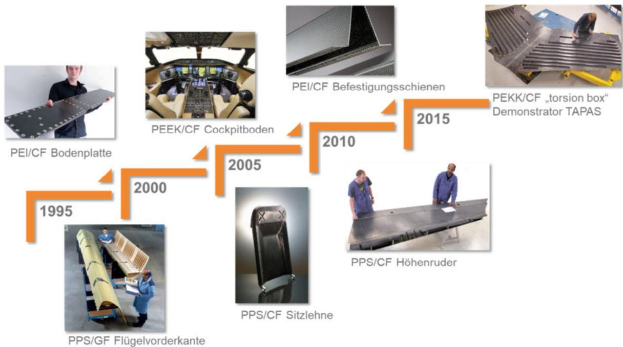
**Abbildung 11** Zeitstrahl mit Strukturanwendungen von faserverstärkten Thermoplasten in der Luftfahrtindustrie
